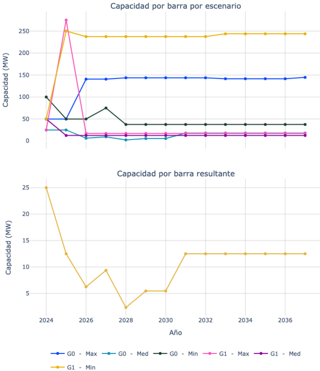
Figura 36. Capacidad de transporte de la subestación Santander 115.
