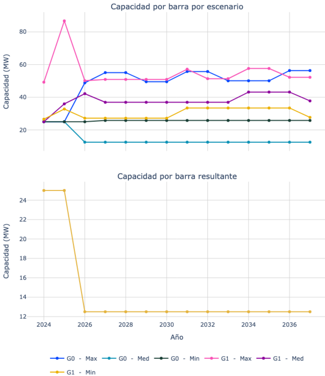
Figura 21. Capacidad de transporte de la subestación Panamericana 115.
