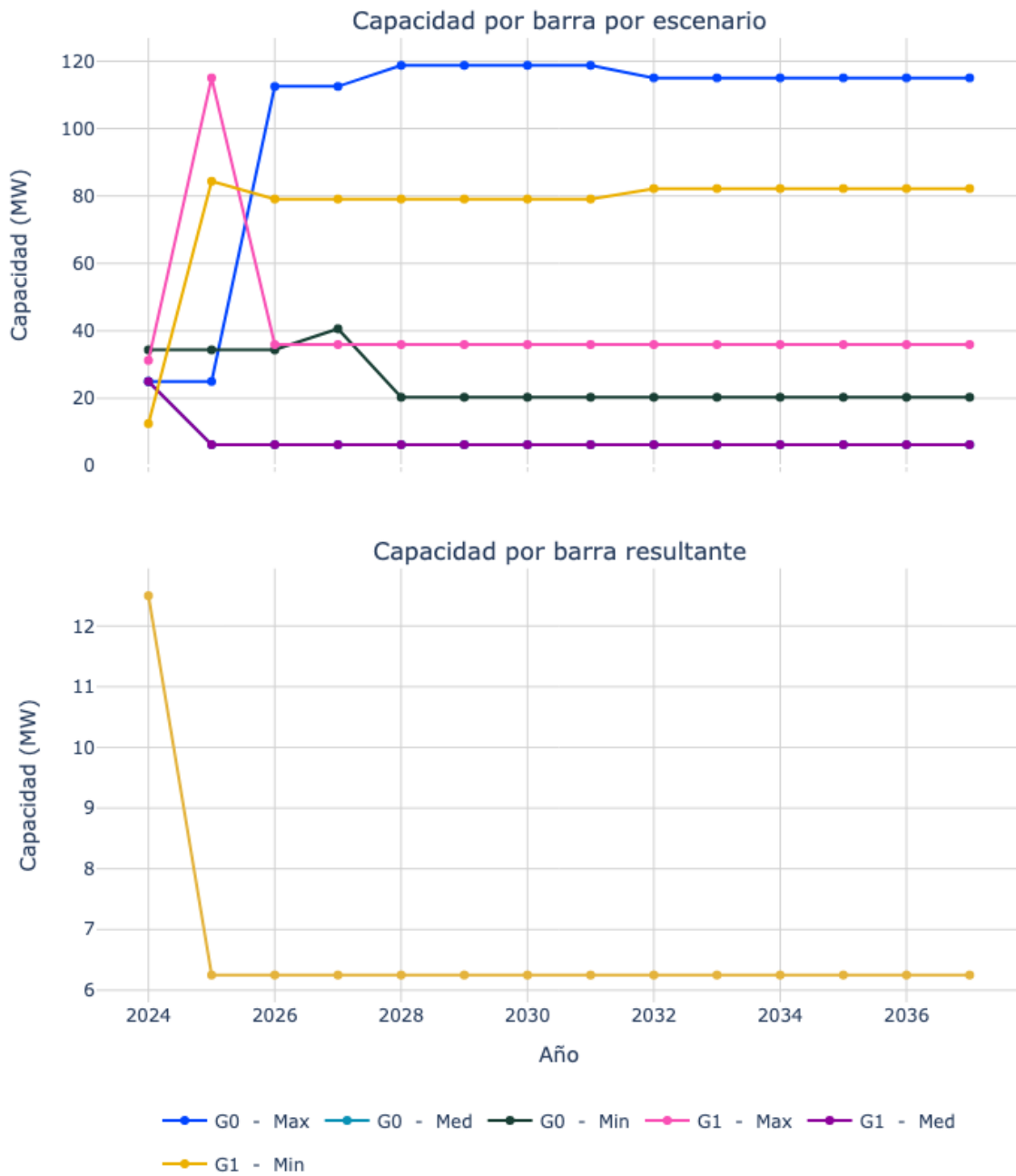
Figura 9. Capacidad de transporte de la subestación El Zaque 115.
