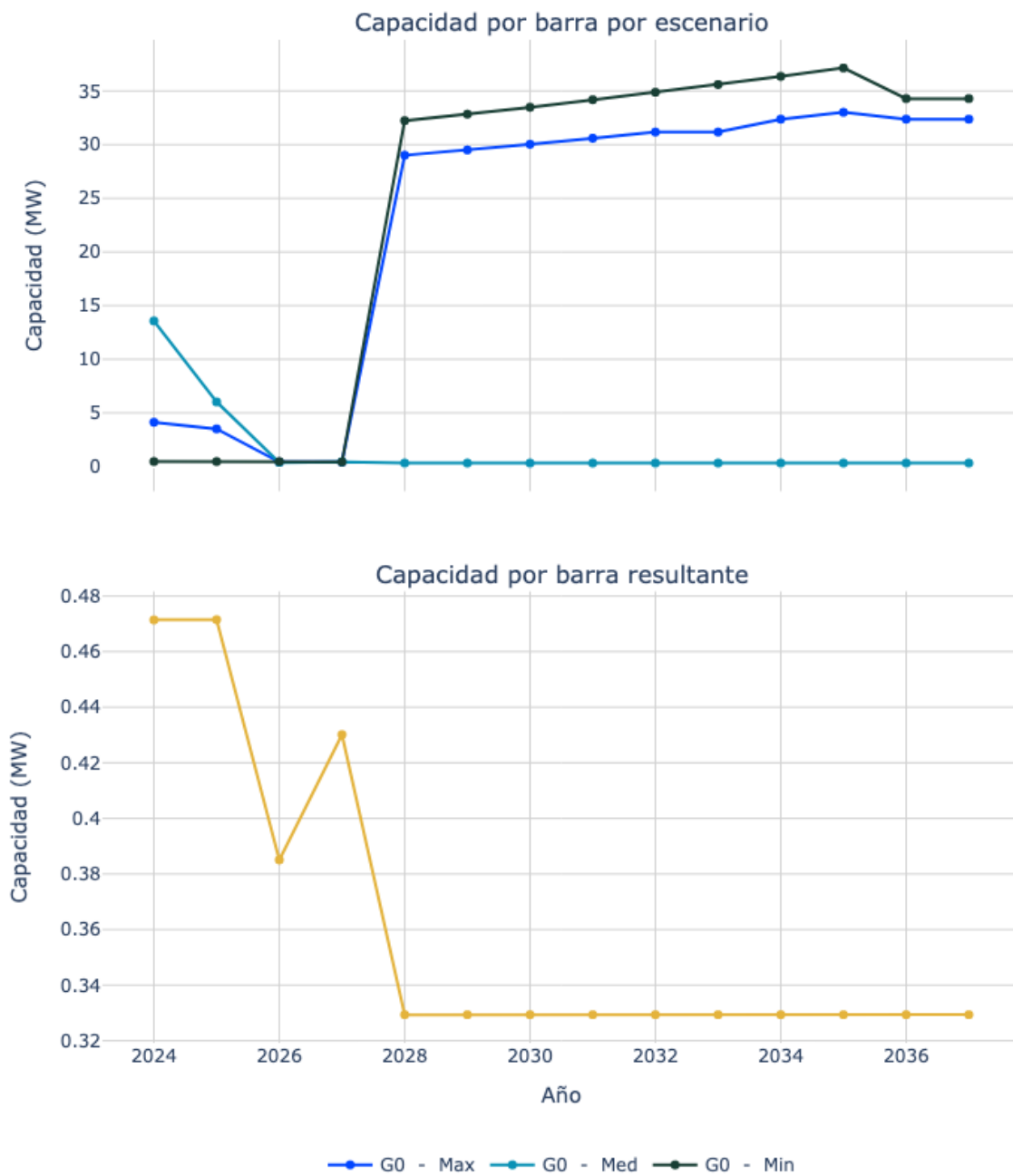
Figura 47. Capacidad de transporte de la subestación Curumani 34.5.
