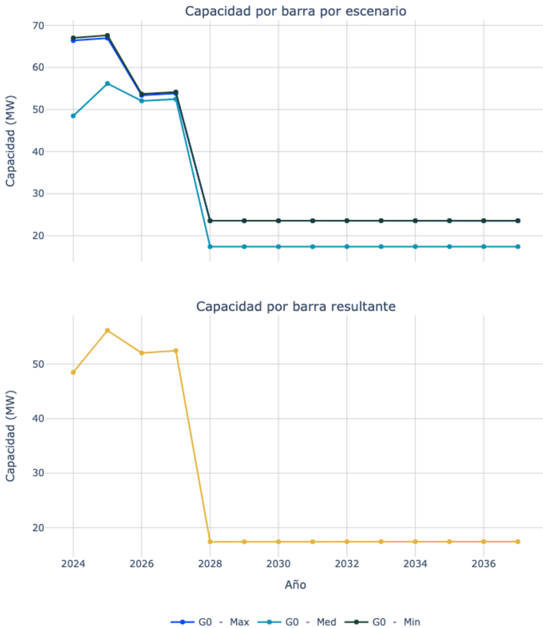
Figura 79. Capacidad de transporte de la subestación LIBERTADOR 1 13.8 kV.
