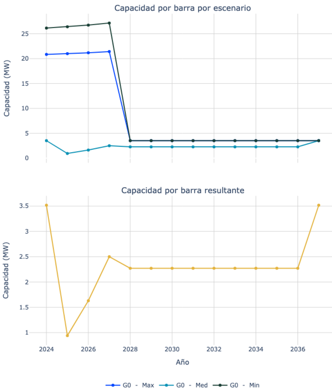
Figura 27. Capacidad de transporte de la subestación Bosconia 13.8.
